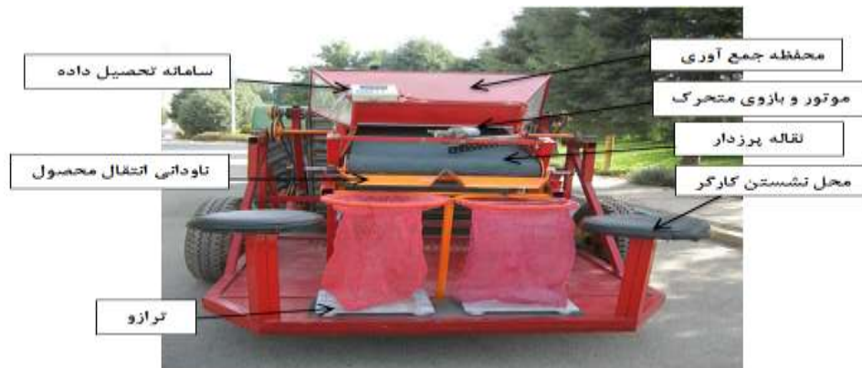
"شکل ۱" اجزای سامانه توزین ماشین جمع آوری سیب زمینی
