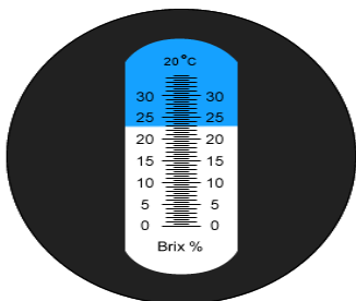
شکل (۱) - استفاده از دستگاه رفراکتومتر دستی برای ارزیابی مواد جامد قابل حل میوه سیب رقم (رد دلشیز)
